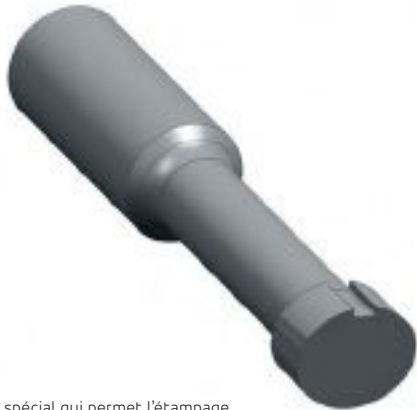
L'outil spécial qui permet l'étampage de la moulure de positionnement.
